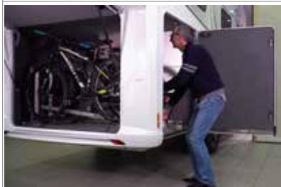
Sollevare la slitta e tirare fino a battuta sul finecorsa
