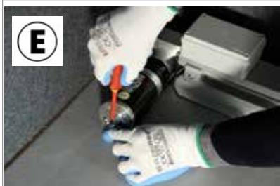
● Bloccare il MOTORE con vite autofilettante. In alcune tipologie di pavimenti potrebbe essere necessario bloccare con viti e dado.
