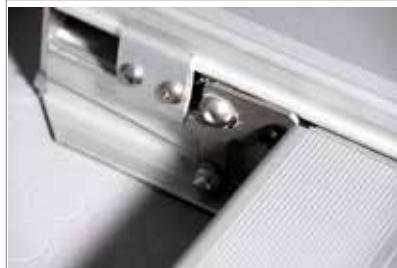
● Pinza correttamente bloccata sul finecorsa
