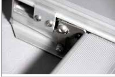
● Pinza correttamente bloccata sul finecorsa
