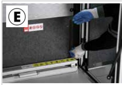
● Collegare il cavo di alimentazione di sezione minima 1,5 mm<sup>2</sup> protetto da fusibile 15 A all'impianto elettrico del camper
