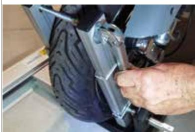
● Mantenere frenato lo scooter con la mano destra e bloccare la ruota con la manovella del morsetto superiore
