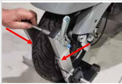
● Abbassare la parte superiore della pinza fino a far toccare il perno sullo pneumatico. Bloccare il morsetto avvitando i due grani
